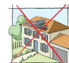
pose au milieu d'une toiture à 4 pans
